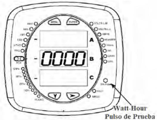
Figura 6.3 : Pulso de Prueba Watt-Hora
