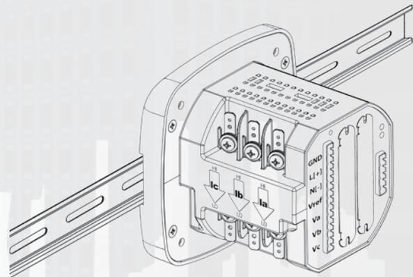
Shark® 200T - Transductor Montado en RIEL DIN
